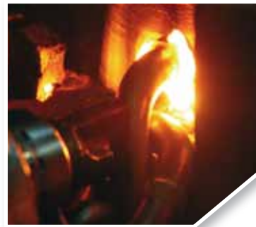
Conformado y soldado del eslabón Forming and link welding
